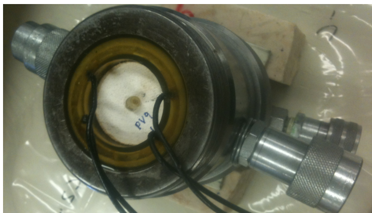
Figura 7 - Inserção dos cabos coaxiais na base da camisa da célula de Hoek.
