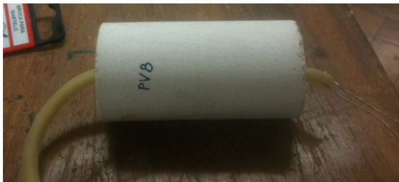
Figura 19 – Mangueiras introduzidas com sonda de arame.
